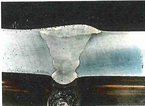
**Mikroschliffuntersuchung nach DIN EN ISO 17639**
